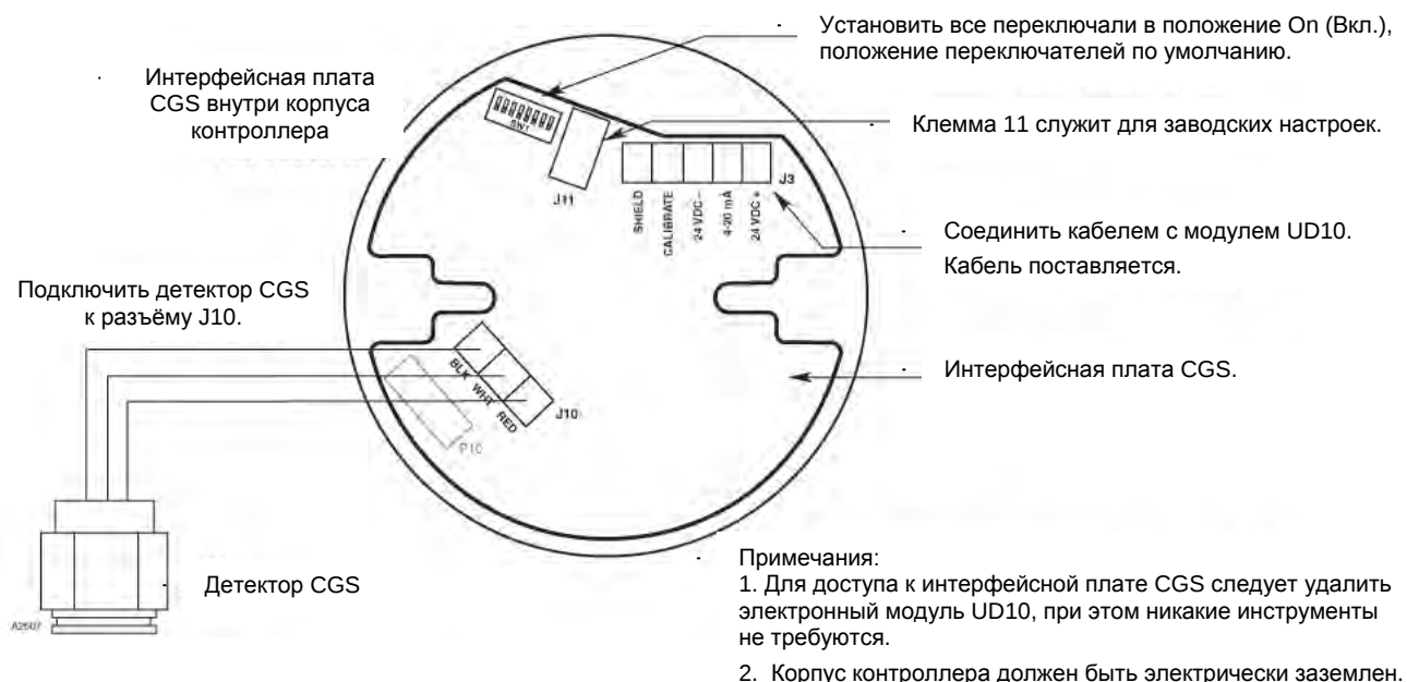
Схема подключения детектора CGS непосредственно к контроллеру UD10.
