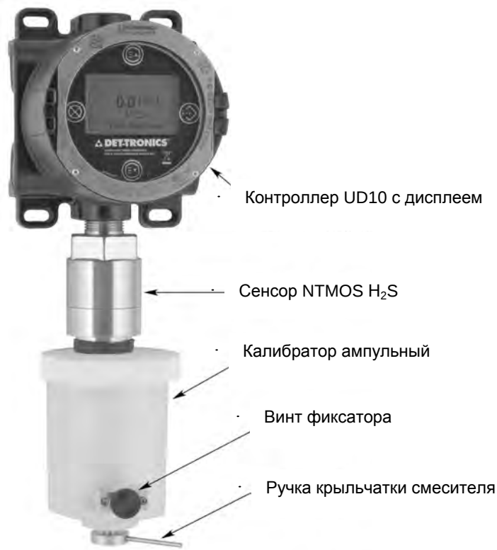
Крепление ампульного калибратора к газоанализатору NTMOS
