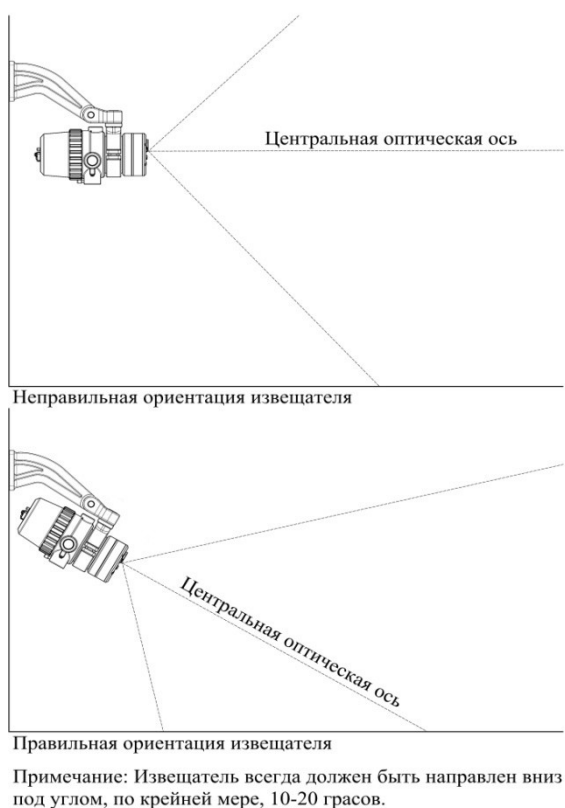
Рисунок 6 – Установка извещателя по отношению к горизонту.
