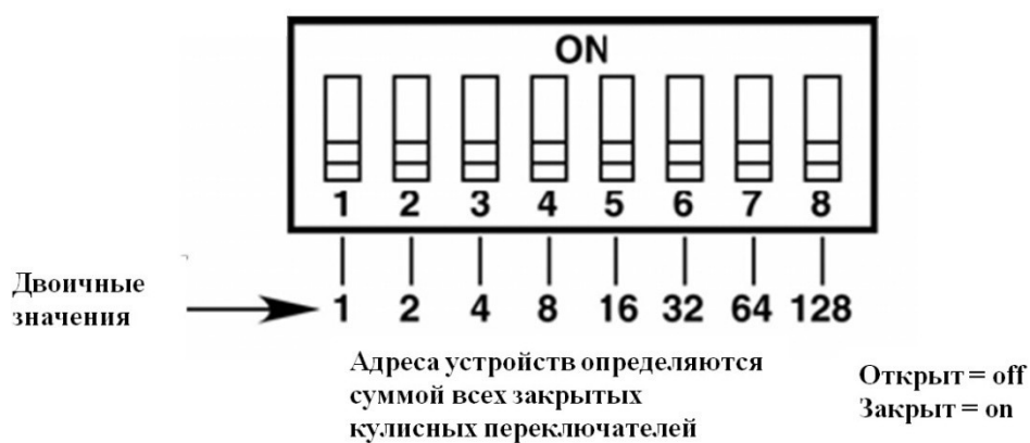
Рисунок 18 – Адресные переключатели извещателя
