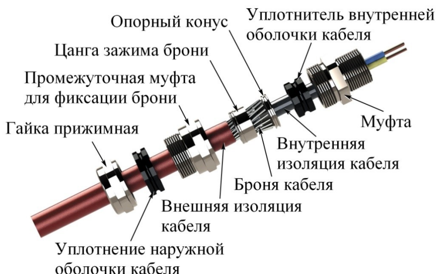
Рисунок 8 – Пример монтажа кабельного ввода
