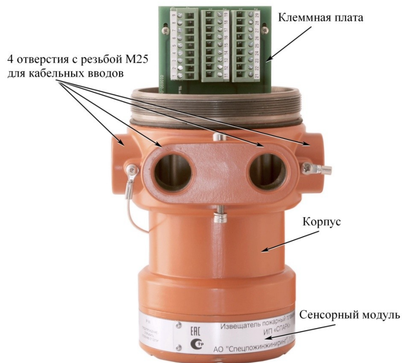
Рисунок 2 – Извещатель со снятой задней крышкой.
