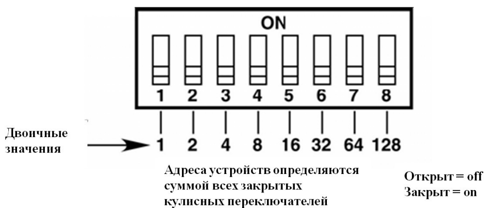
Рисунок 18 – Адресные переключатели извещателя
