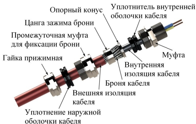
Рисунок 8 – Пример монтажа кабельного ввода
