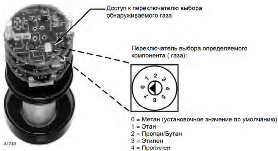
Рис. 14. Расположение переключателя выбора определяемого газа внизу электронного блока.
