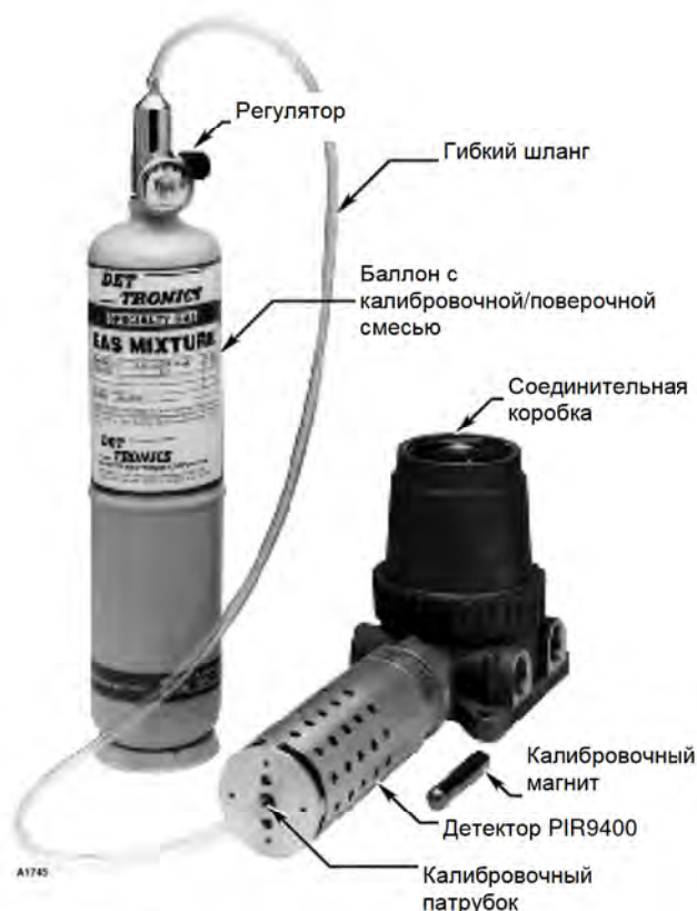
Рис. 24. Подключение детектора в алюминиевом корпусе для операции калибровки.
