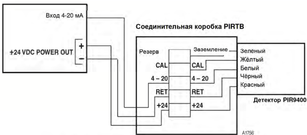
Рис. 16. Типовая схема подключения детектора PIR9400 с использованием соединительной коробки PIRTB.
