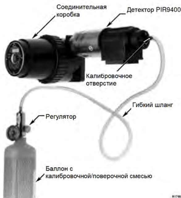
Рис. 25. Подключение детектора в корпусе из нержавеющей стали для операции калибровки.
