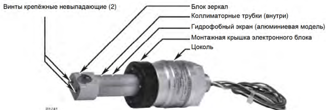
Рис. 12. ИК модуль и цокольная сборка.
